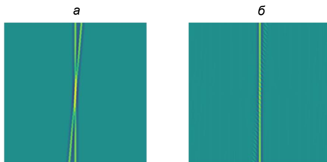
Рис. 7. Разделение плоских волн, пересекающихся под углом в 5^\circ : а – исходная модель; б – результат подавления наклонной плоской волны
