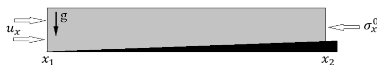
Рис. 1. Схема нагружения осадочного слоя среды
