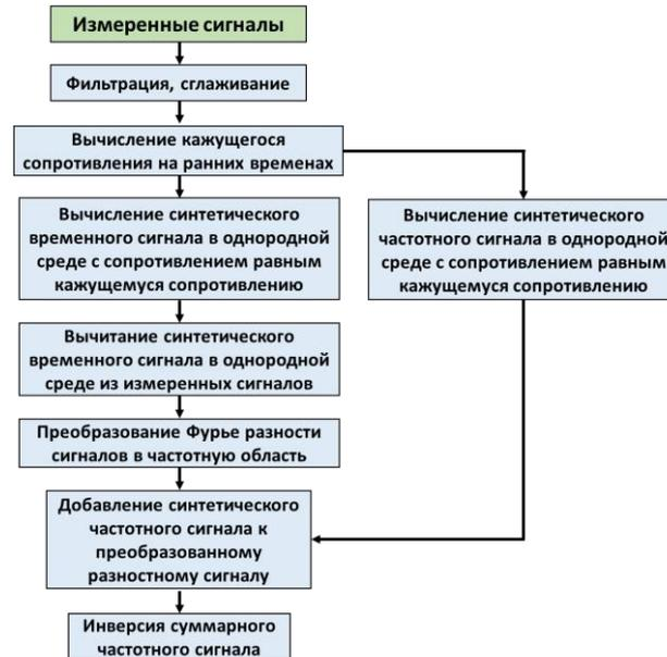
Рис. 4. Алгоритм преобразования сигналов для последующей инверсии
