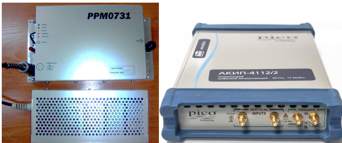
Рис. 15. Внешний вид высоковольтного генератора PPM0731 (слева) и стробоскопического осциллографа АКИП-4112/2 (справа)
