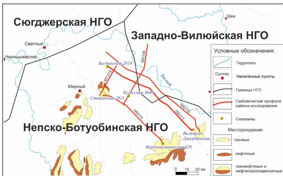
Рис. 2. Схема изученности сейсморазведкой и глубоким бурением
