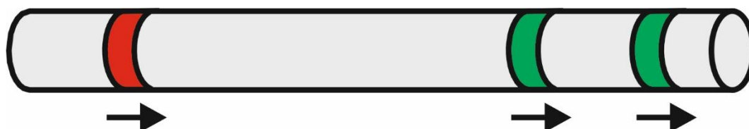
Рис. 1. Схема конфигурации прибора EWR, красным цветом обозначена генераторная катушка, зеленым цветом – приемные катушки, стрелками показана ориентация катушек
