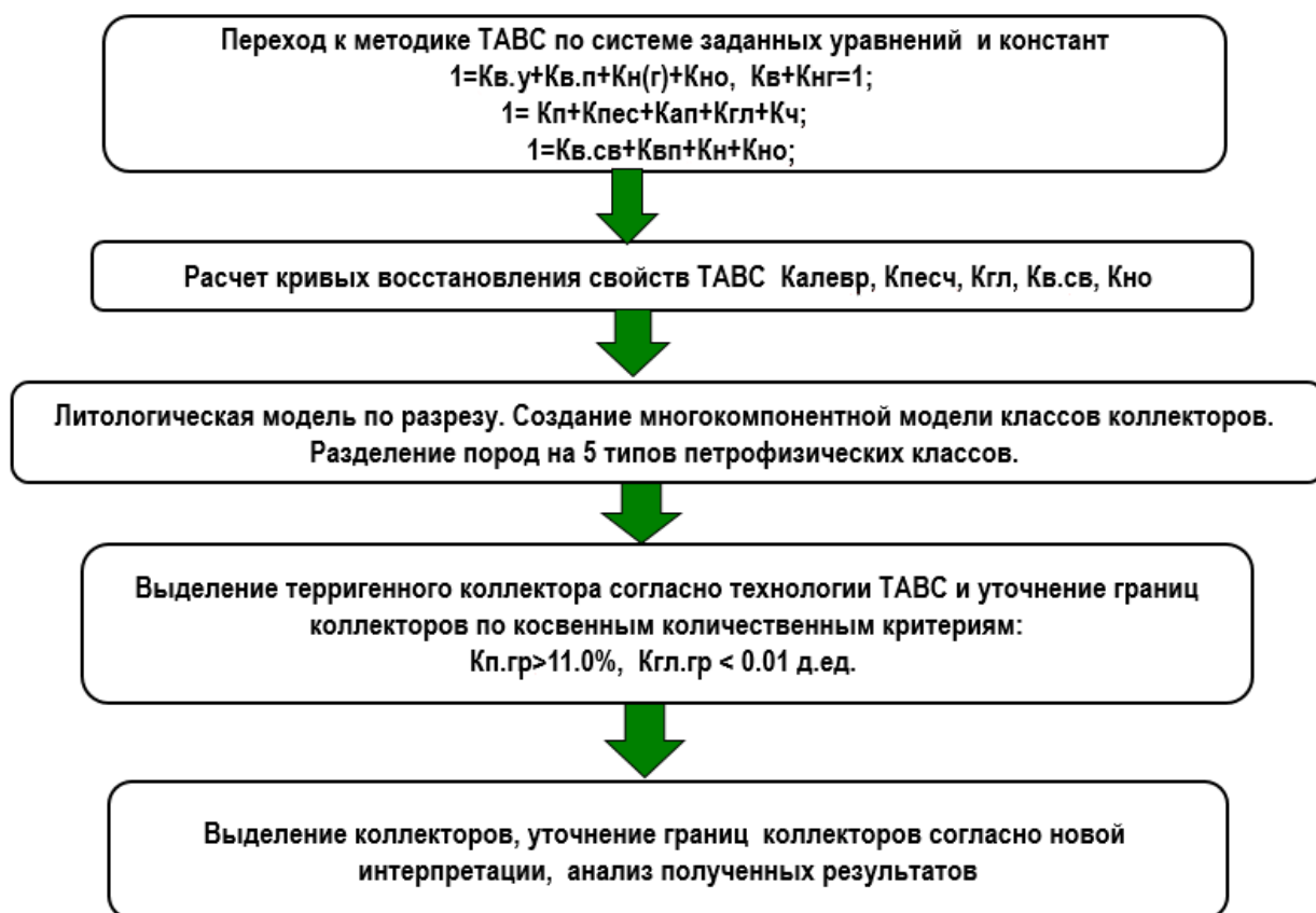
Рис. 3. Блок-схема интерпретации ГИС восстановлений свойств по методике ТАВС
