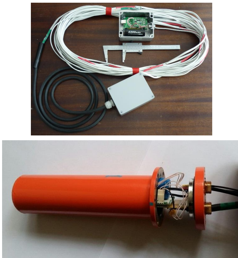
Рис. 2. Вид СТМ во влагозащитном и герметичном корпусах
