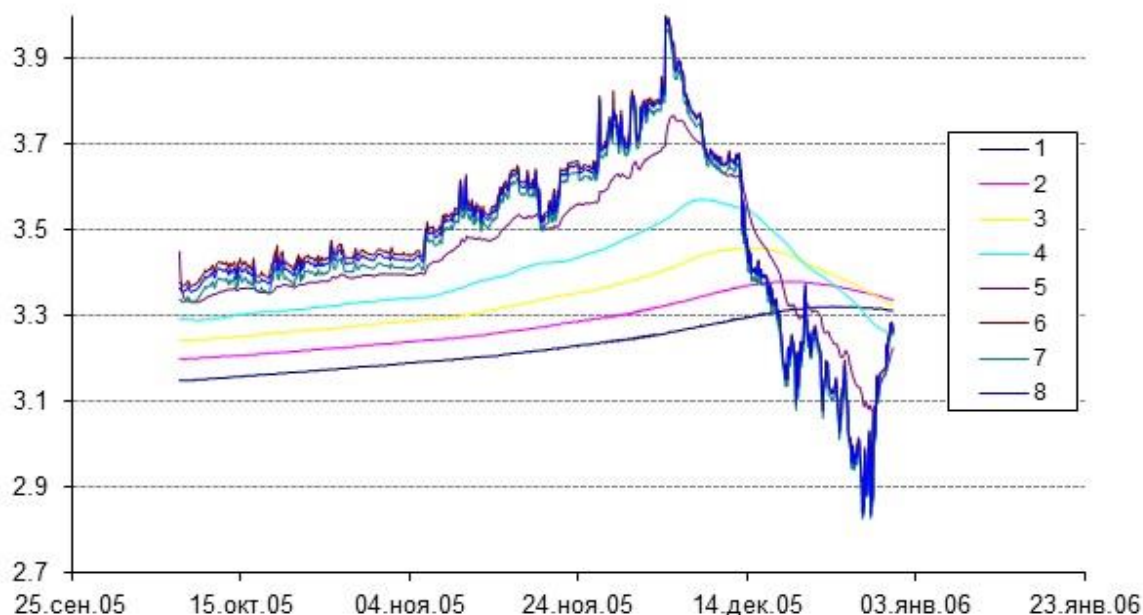
Рис. 4. Температура придонной воды и илов дна центральной части Телецкого озера в октябре–декабре 2005 г. Номера восьми датчиков указаны справа от графиков. Датчики 6–8 расположены в придонном слое воды, датчик 5 – на дне, датчики 4–1 – ниже дна на 35, 70, 105 и 140 см соответственно
