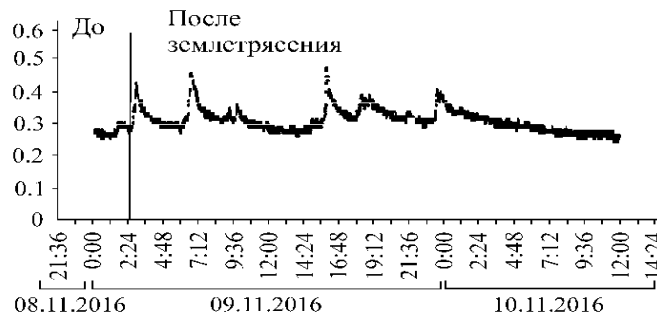
Рис. 8. Медленные колебательные движения концентрации метана [Опарин и др., 2021], обусловленные колебаниями пористости и удельной поверхности пор. Скорость первой волны 2.5 м/с.
