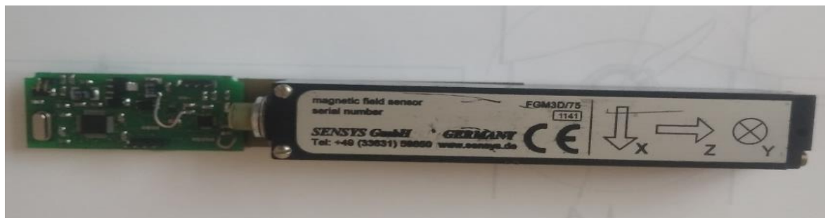
Рис. 3. Общий вид измерительного блока (слева – модуль ИНС)
