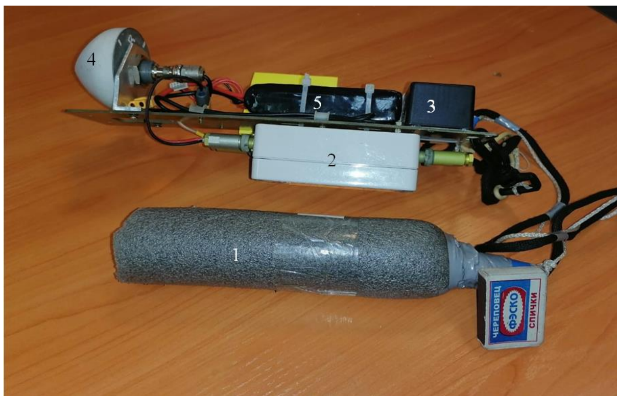
Рис. 2. Элементы МИИС: 1 – измерительный блок, 2 – блок электронного обеспечения, 3 – приемник СНС, 4 – антенна СНС, 5 – аккумулятор
