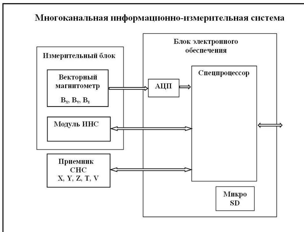
Рис. 1. Функциональная схема МИИС, СНС – спутниковая навигационная система
