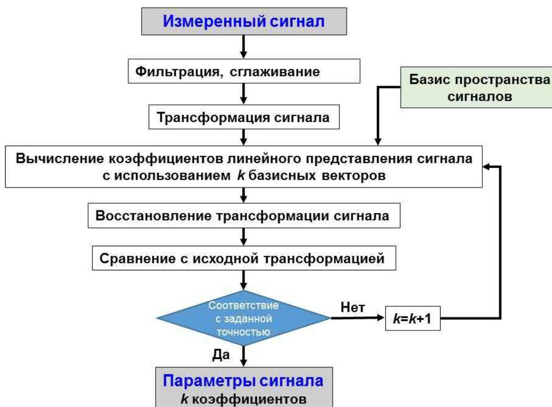
Рис. 2. Блок-схема метода собственных значений
