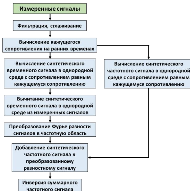
Рис. 4. Алгоритм преобразования сигналов для последующей инверсии
