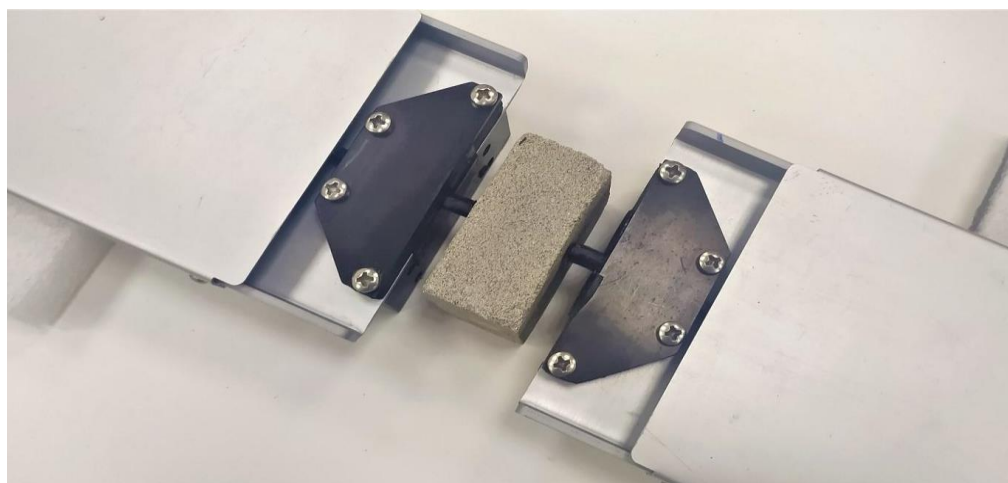
Рис. 5. Измерение скорости звука в образце
