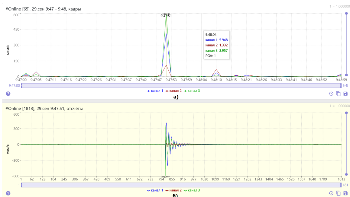
Рис. 2. Ударное воздействие с близкорасположенным источником колебаний: а – навигационный интерактивный график с отображениями кадровых максимумов; б – детальное отображение сейсмической записи
