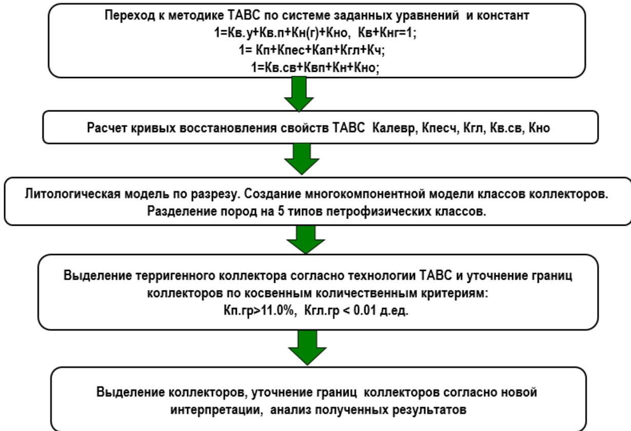
Рис. 3. Блок-схема интерпретации ГИС восстановлений свойств по методике ТАВС
