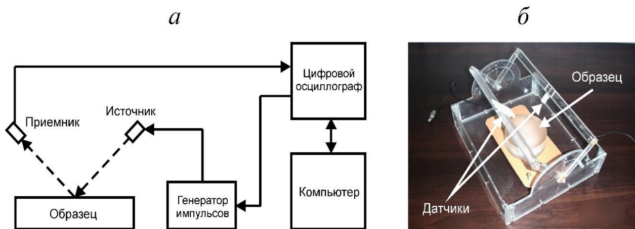
Рис. 2. Схема эксперимента (а) и конструкция рычажного устройства (б)
